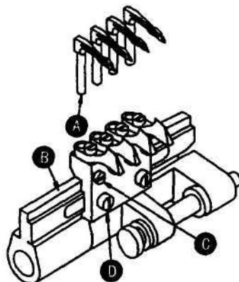
Установить петлитель машины под углом 2 градуса. Разница уровня в пределах 16 мм составляет примерно 0,5 мм. Зазор между петлителем и иглой, когда носик петлителя проходит мимо фаски иглы должен составлять 0 – 0,1 мм.
