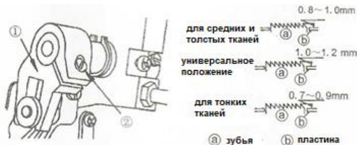
1) Зубчатый транспортер настраивается на заводе-изготовителе так, чтобы он выходил из поверхности пластины горловины на 0,75-0,85 мм (от 1,15 до 1,25 мм для толстого материала).
